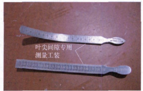
图7 RB211防磨带叶尖间测量工具
