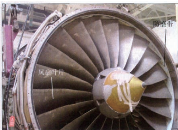
图2 RB211风扇叶片和防磨带
